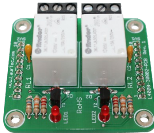
Figura 6: Scheda miniCOM Relays a montaggio ultimato.
