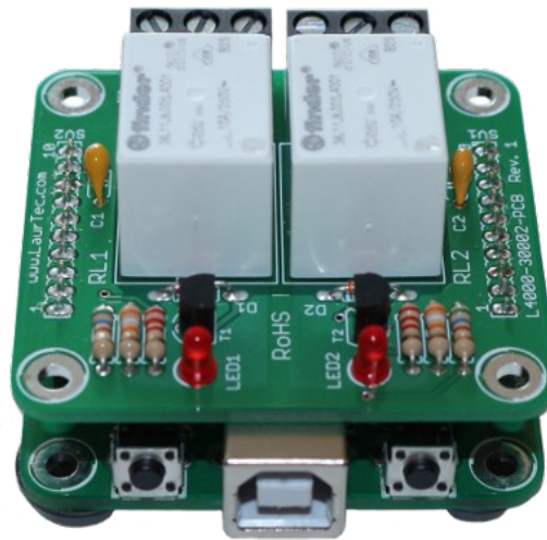
Figura 7: Scheda miniCOM Relays a montaggio ultimato e collegata a miniCOM USB.
